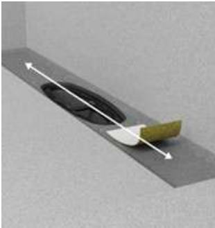
1. Slipa ovansidan på golvbrunnen med fint sandpapper.
